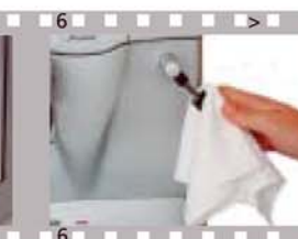
6 Düse mit feuchten Lappen reinigen, damit der Getränkschaum nicht eintrocknet
