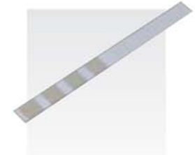
Teststreifen für Wasserhärte
