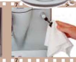
7 Düse mit feuchten Lappen reinigen, damit der Getränkschaum nicht eintrocknet
